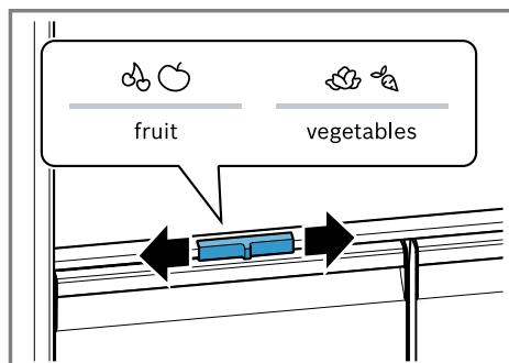
Vlažnost zraka u ladici za voće i povrće možete namjestiti prema vrsti i količini namirnica koje treba čuvati u hladnjaku pomicanjem regulatora vlažnosti zraka:
