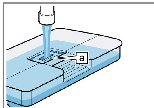
6. Den gefüllten Wassertank einsetzen ①. Dabei darauf achten, dass der Wassertank an den Halterungen **a** einrastet.
