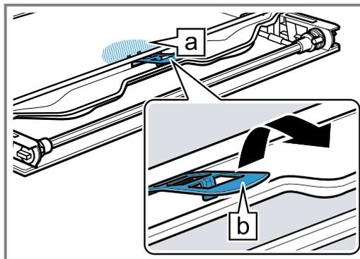
8. Die Zwischenscheibe von unten anheben ① und in Pfeilrichtung herausnehmen ②.
