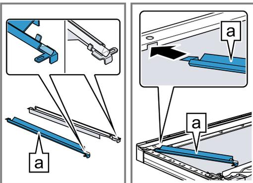
7. Den Reflektor **a** einsetzen und in Spalte **b** einrasten.
