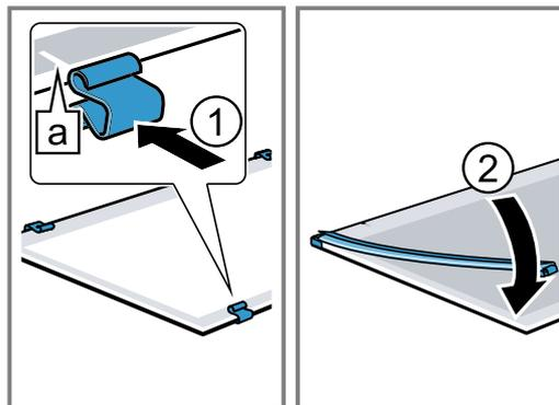
**3. Die Zwischenscheibe mit Abstandshalter und Dichtungen in Pfeilrichtung einsetzen **1**.**
