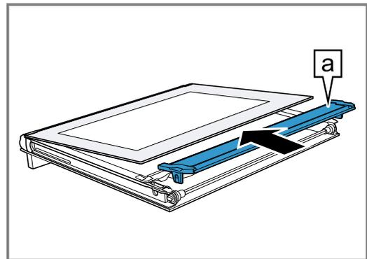
12. Die Innenscheibe mit der Halterung **a** in die Öffnung einsetzen.
