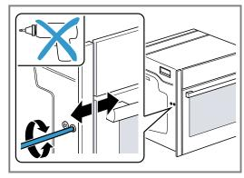
Mit dem Uhrzeigersinn: Spalt vergrößern Gegen den Uhrzeigersinn: Spalt verkleinern
