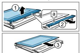
5. Die Zwischenscheibe im Bereich a leicht nach unten drücken und die Halterung b vorsichtig anheben, bis sie sich herausziehen lässt.
