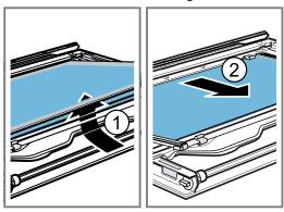
7. Bei Bedarf zur Reinigung die Abstandshalter 🗵 und die Dichtungen 🗈 abnehmen.
