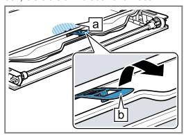
**6.** Die erste und zweite Zwischenscheibe von unten anheben ① und in Pfeilrichtung herausnehmen ②.
