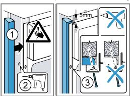
Die Gerätetür etwas öffnen, die Blenden anlegen und zuerst oben, dann unten festschrauben.
