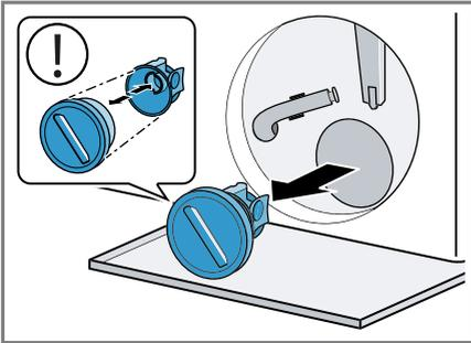
2. Limpe o interior, a rosca da tampa da bomba e a carcaça da bomba.
