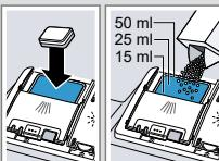
2. Den Deckel der Reinigerkammer schließen.
