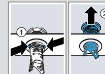
5. Unter fließendem Wasser die Siebelemente reinigen.
