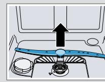
3. Unter fließendem Wasser die Austrittsdüsen der Sprüharme auf Verstopfungen prüfen und gegebenenfalls Fremdkörper entfernen.
