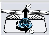
2. Das Grobsieb gegen den Uhrzeigersinn drehen (1) und das Siebsystem herausnehmen (2).
