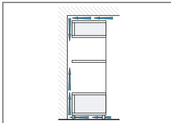
No montar los aparatos a demasiada altura, a fin de poder retirar los accesorios sin problemas.
