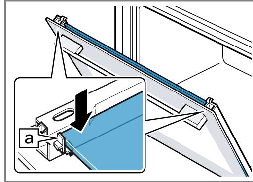
5. Otvorite vrata uređaja i zakačite zaptivku vrata.
