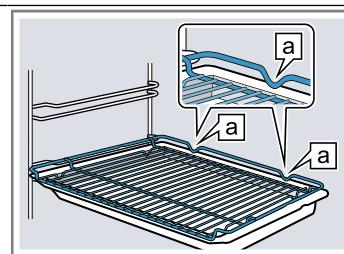
3. Da biste na visine za ubacivanje sa šinama za izvlačenje stavili pribor, izvucite šine za izvlačenje.
