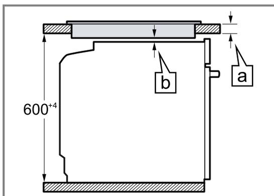
En función de la separación mínima requerida  $\text{[a]}$  se determina el grosor mínimo de la encimera  $\text{[a]}$ .
