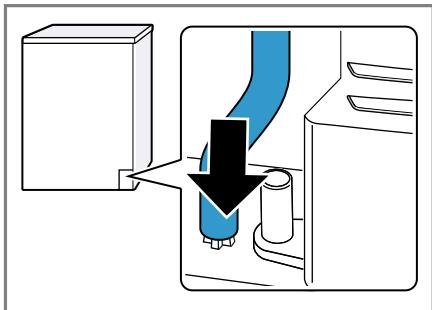
3. Poussez le tuyau d'évacuation d'eau sur le manchon jusqu'en bûtee.
