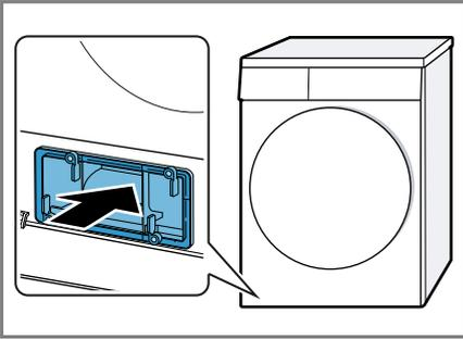
2. Die Hebel der Wärmetauscherabdeckung schließen.
