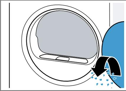
3. Das zweiteilige Flusensieb entfernen.
