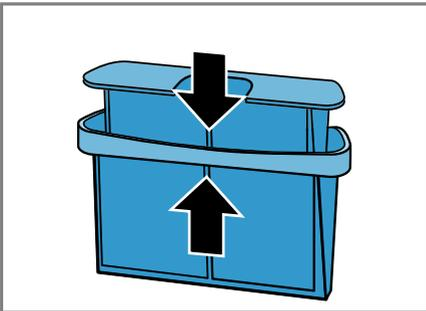
10. Das zweiteilige Flusensieb einsetzen.
