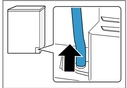
Der Kondenswasserschlauch ist werkseitig am Stutzen angeschlossen.
