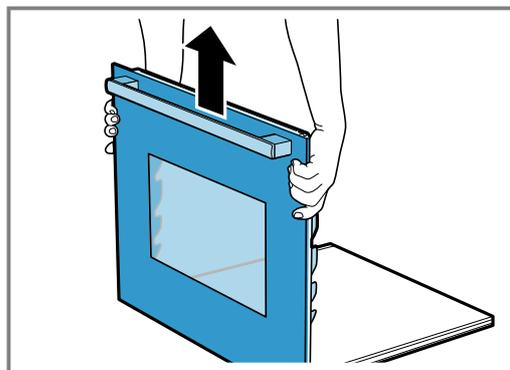
3. Die Gerätetür vorsichtig auf einer ebenen Fläche absetzen. Auf der Unterseite der Gerätetür befinden sich empfindliche Bauteile.
