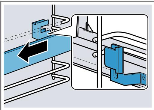
4. Die Auszugsschiene entfernen.
