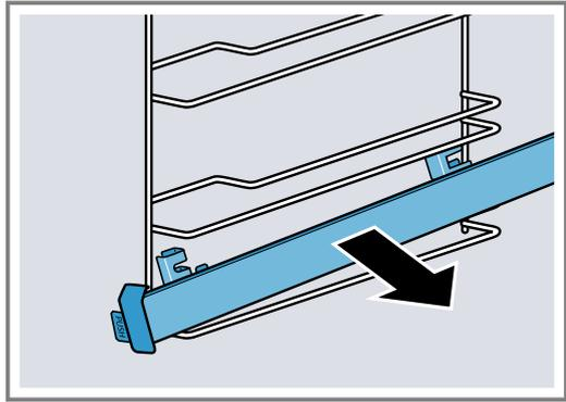
5. Die Auszugsschiene reinigen.
