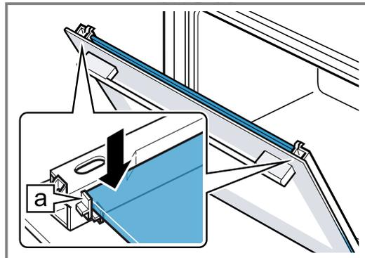
5. Die Gerätetür öffnen und Türdichtung einhängen.
