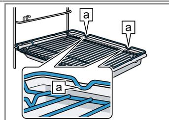
Rost Den Rost mit der offenen Seite zur Gerätetür und der Krümmung
