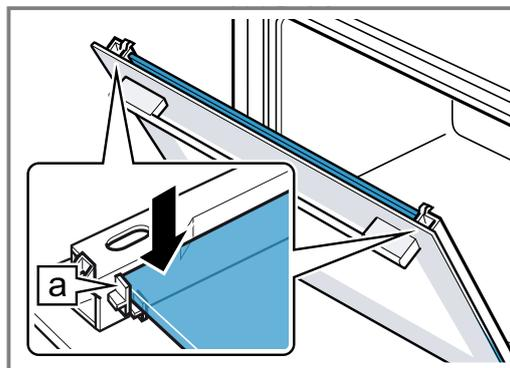
5. Die Gerätetür öffnen und Türdichtung einhängen.
