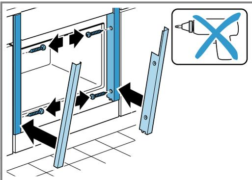
7. Bei Bedarf den Spalt zwischen Gerätetür und den seitlichen Blenden über die obere Schraube links und rechts anpassen.
