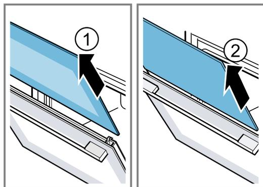
8. Die Gerätetür öffnen und Türdichtung abnehmen.
