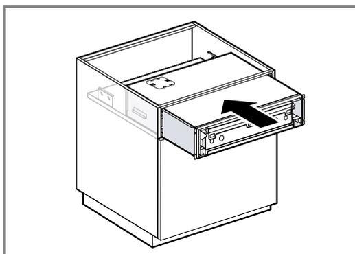
3. Se não for possível fazer deslizar o aparelho para dentro, regule a cantoneira de proteção contra inclinação em altura. Para o efeito, solte os parafusos e empurre as cantoneiras de proteção contra inclinação para cima.
