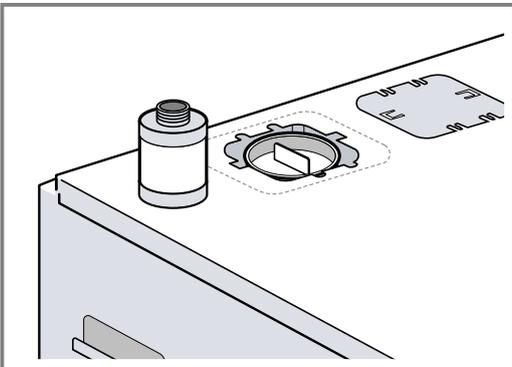
2. Remova a proteção de transporte da bomba no lado de cima do aparelho.
