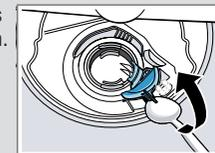
5. Die Pumpenabdeckung schräg nach innen anheben und entfernen.
