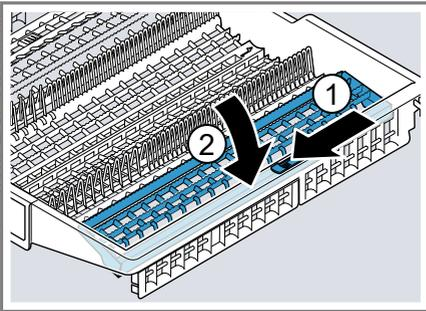
2. Um die vorderen Stachelreihen umzuklappen, den Hebel nach vorne drücken und die Klappstacheln umklappen ①.
