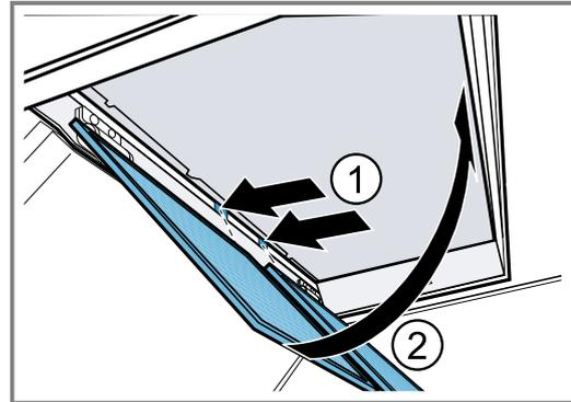
5. Sicherstellen, dass die Fettfilter korrekt eingesetzt sind.
