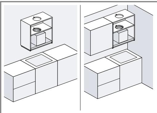
Um die Schrankwände zu stabilisieren, mit einem Schraubendreher rechts und links die Schrauben eindrehen.
