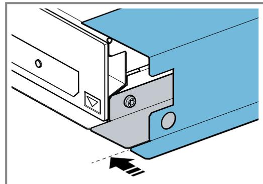
3. Bei einer Schranktiefe (Außenmaß) von 330 mm bis 360 mm, den Kanaltiefenausgleich einhängen.
