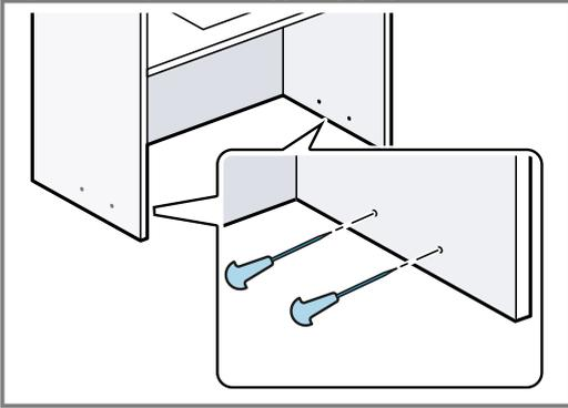
8. Bei einer Wandstärke von 16 mm: Die Schienen auf die Montagehilfen setzen ① und an den Schrank-Seitenwänden festschrauben ②.
