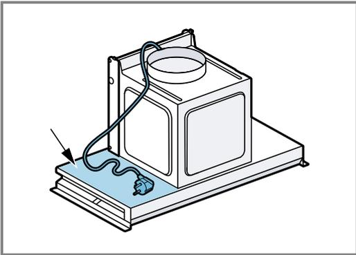
2. Das Gerät mindestens bis zur Hälfte in die Schienen schieben ① und den Netzstecker durch den Ausschnitt führen ②.
