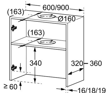
4. Den Ausschnitt für das Abluftrohr im Zwischenboden herstellen.
