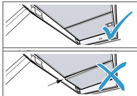
6. Sicherstellen, dass die Verriegelungen einrasten.
