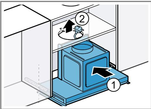
3. Das Gerät bis zum Anschlag in den Schrank schieben.
