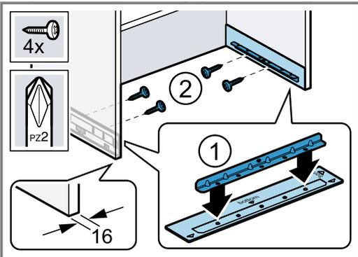
9. Bei einer Wandstärke von 18 mm und 19 mm: Die Schienen ohne Montagehilfe festschrauben.
