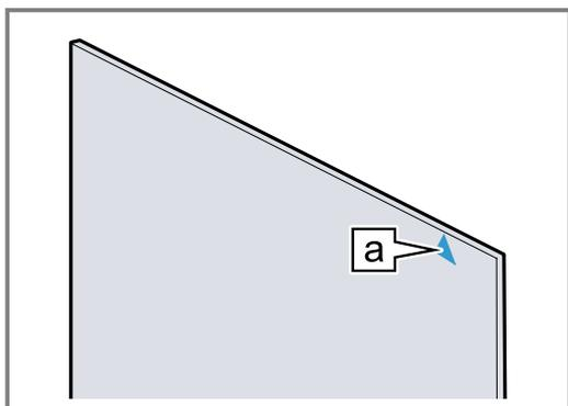
2. Inserire il pannello intermedio sotto il fermo **a** e ① premerlo in alto e fissarlo.
