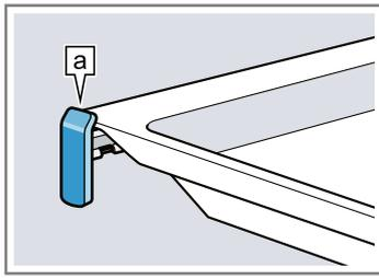
**Nota:** Una volta estratte del tutto, le guide di estrazione si innestano. Spingere indietro con una leggera pressione le guide di estrazione nel vano cottura.
