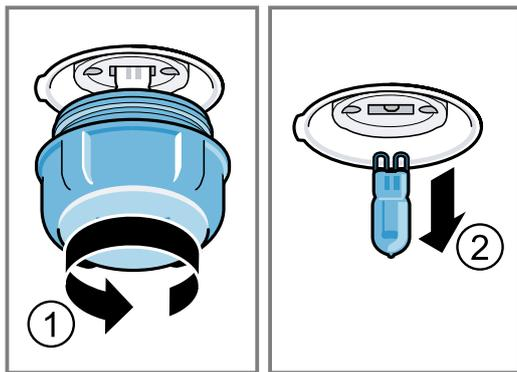
4. Inserire la lampadina alogena nell'attacco. Fare attenzione alla posizione del perno.
