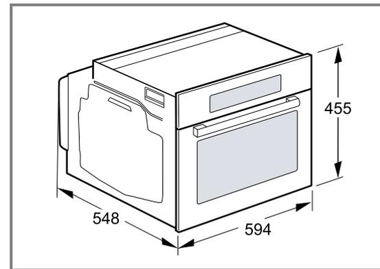
**30.3 Einbau unter einer Arbeitsplatte**
