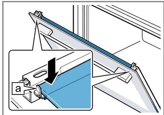
5. Die Gerätetür öffnen und Türdichtung einhängen.
