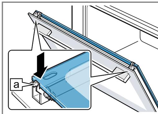
**8.** Die Türabdeckung aufsetzen **①** und andrücken, bis sie hörbar einrastet.**9.** Die Gerätetür ganz öffnen.
