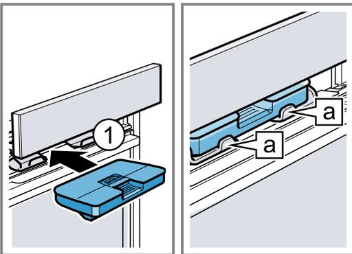
7. Die Bedienblende langsam nach unten schieben, dann nach hinten drücken, bis die Bedienblende vollständig geschlossen ist.
