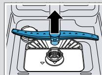
3. Unter fließendem Wasser die Austrittsdüsen der Sprüharme auf Verstopfungen prüfen und gegebenenfalls Fremdkörper entfernen.
