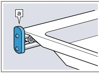
**Hinweis:** Die Auszugsschienen mit etwas Druck zurück in den Garraum schieben.
