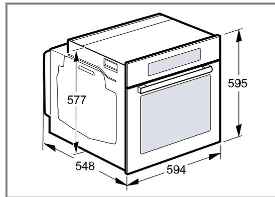
**28.3 Einbau unter einer Arbeitsplatte**
