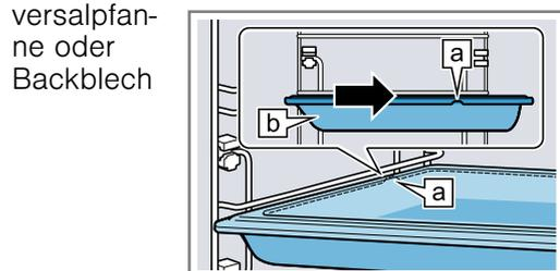
3. Um das Zubehör bei Einschubhöhen mit Auszugsschienen aufzulegen, die Auszugsschienen herausziehen.
