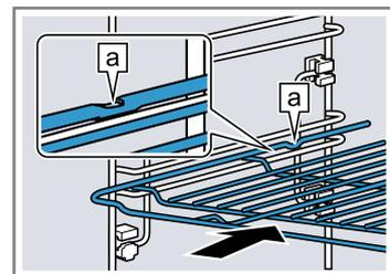
Blech Das Blech mit der Abschrägung
