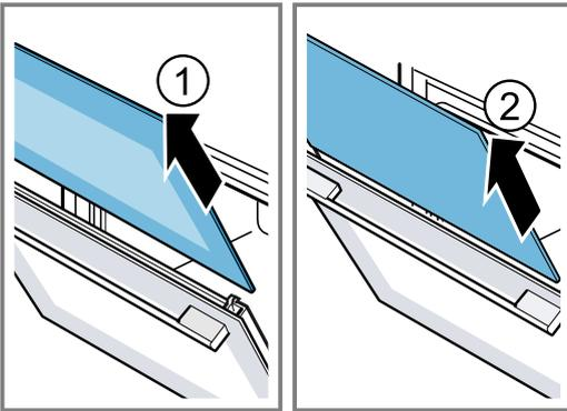
8. Die Gerätetür öffnen und Türdichtung abnehmen.
