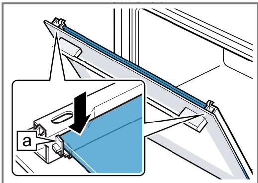
5. Die Gerätetür öffnen und Türdichtung einhängen.
