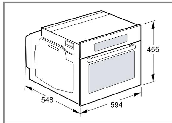
**25.3 Einbau unter einer Arbeitsplatte**
