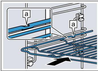
Blech z. B. Universalpfanne oder Backblech Das Blech mit der Abschrägung
