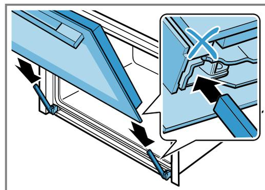
2. Pressione com ambas as mãos, pelo lado de cima, à esquerda e direita, sobre a moldura da porta, para verificar se a porta do aparelho foi inserida até ao batente.
