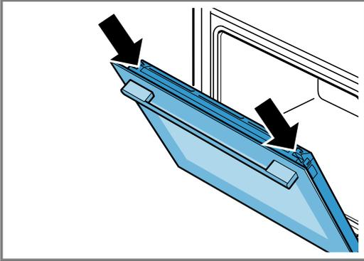
3. Abra completamente a porta do aparelho e pressione no sentido do aparelho.
