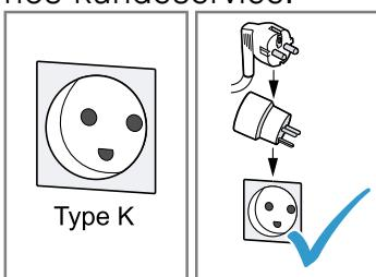
Fagligt ukorrekt tilslutning af apparater over 13 A/3 kW er farlig. Angivelserne om dette apparats effekt findes på typeskiltet
