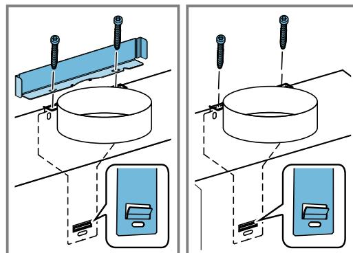
Monter beslagene, hvis der skal monteres en aftræksbeklædning, og hold skruerne fast, mens de spændes til.
