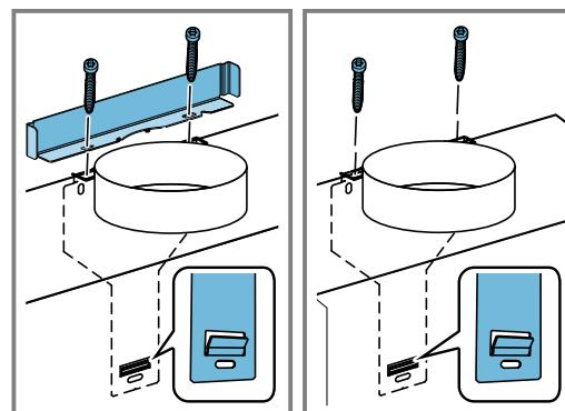
Ska du montera fläktkåpa, montera vinklarna och håll fast när du drar åt skruvarna.
