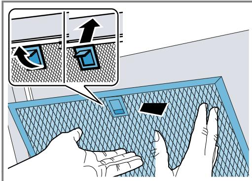
**3. Tryk forsigtigt låseanordningen fremad, hvis fedtfiltret er sat forkert ind, tag fedtfiltret ud, og vend det korrekt.**
