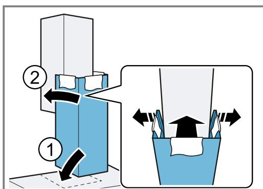
7. Klips den nederste aftræksbeklædning fast på det nederste vinkelbeslag. Pas på, at tilslutningskablerne ikke kommer i klemme.
