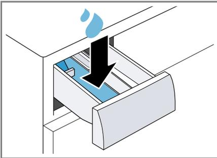
5. Pulvervollwaschmittel in die Kammer II einfüllen.
