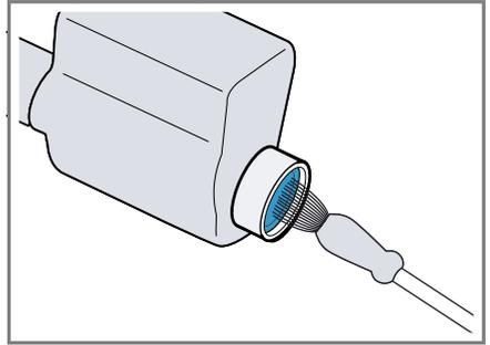
3. Den Wasserzulaufschlauch anschließen und auf Dichtheit prüfen.
