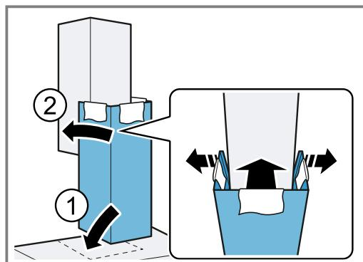
7. Klips den nederste aftræksbeklædning fast på det nederste vinkelbeslag. Pas på, at tilslutningskablerne ikke kommer i klemme.
