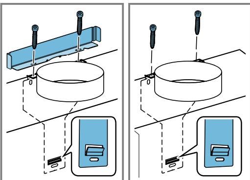
Ska du montera fläktkåpa, montera vinklarna och håll fast när du drar åt skruvarna.
