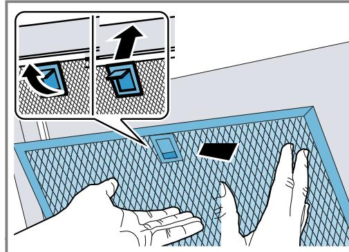
3. Tryk forsigtigt låseanordningen fremad, hvis fedtfiltret er sat forkert ind, tag fedtfiltret ud, og vend det korrekt.
