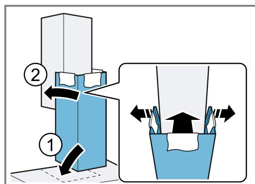
7. Klips fast den nedre delen av avtrekkskanalen på den nedre holdevinkelen.
