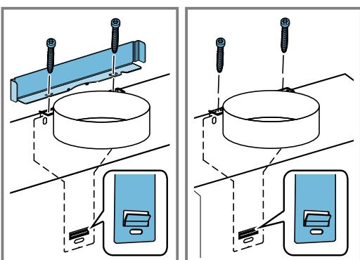
Dersom du skal montere en avtrekkskanal, setter du inn vinkelen og holder den fast når du trekker til skruene.
