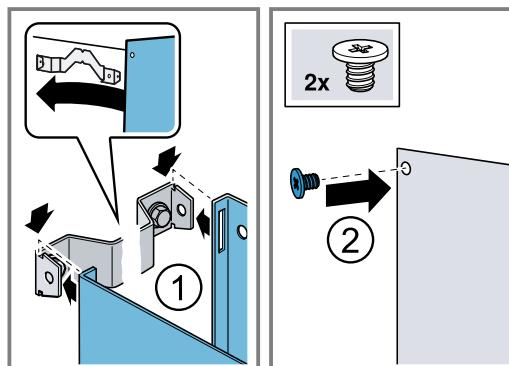
5. **Bemærk:** Læg bløde klude over kanterne på den udvendige aftræksbeklædning for at undgå ridser. Sæt den nederste aftræksbeklædning på apparatet, og træk dem lidt fra hinanden. ①
