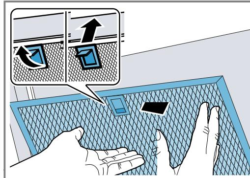
3. Jos asetit rasvasuodattimen paikalleen väärin, paina lukitsinta varovasti eteenpäin, ota rasvasuodatin pois paikaltaan ja aseta se oikein paikalleen.
