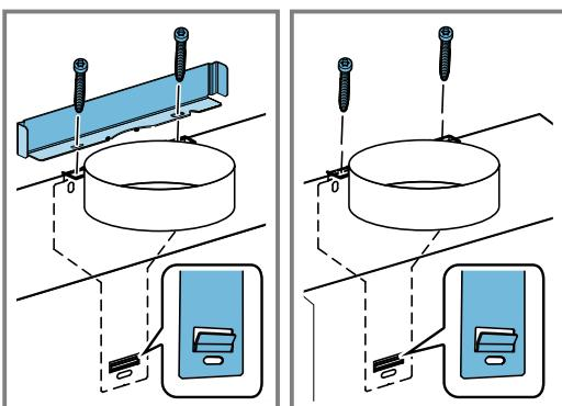
Monter beslagene, hvis der skal monteres en aftræksbeklædning, og hold skruerne fast, mens de spændes til.
