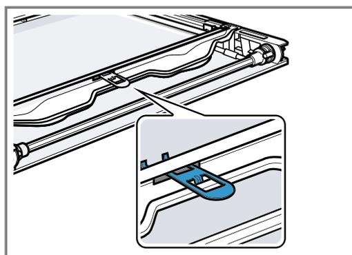
3. Die Innenscheibe schräg nach hinten in die Befestigungsschiene [a] einsetzen ①.
