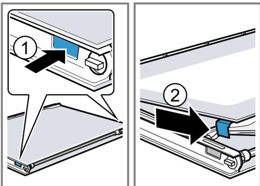
4. Die Zwischenscheibe im Bereich [a] leicht nach unten drücken und die Halterung [b] vorsichtig anheben, bis sie sich herausziehen lässt.
