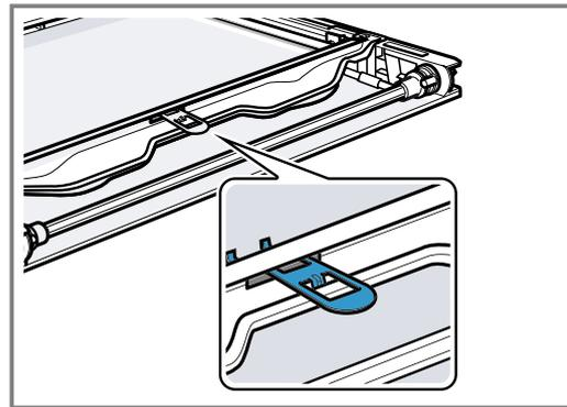
6. Die Innenscheibe schräg nach hinten in die Befestigungsschiene **a** einsetzen ①.
