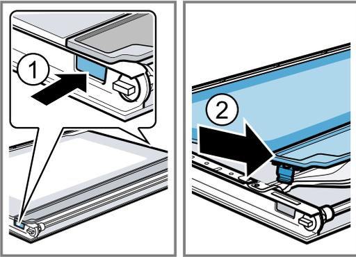
4. Die Zwischenscheibe im Bereich [a] leicht nach unten drücken und die Halterung [b] vorsichtig anheben, bis sie sich herausziehen lässt.
