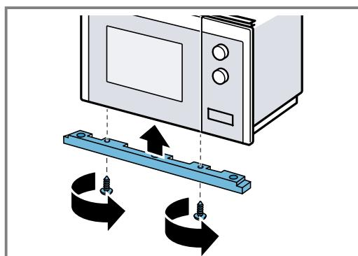
6. Fijar los cuatro soportes de la base del microondas.
