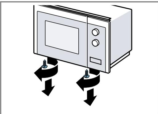
5. Den Einbaurahmen am Mikrowellenboden mit den beiden äußeren Schrauben befestigen.
