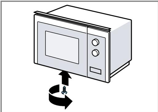
4. De 2 buitenste schroeven aan de bodem van de magnetron losdraaien.
