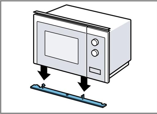
3. Die mittlere Schraube am Mikrowellenboden festschrauben.
