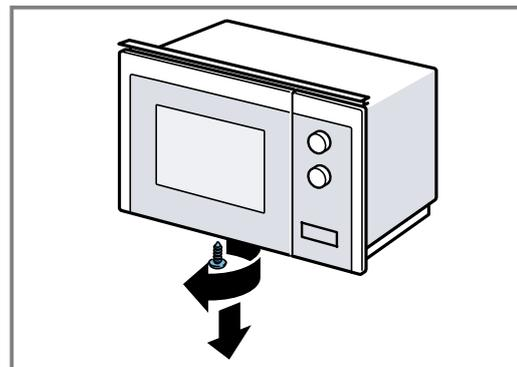
2. Die Abdeckung am Mikrowellenboden entfernen.
