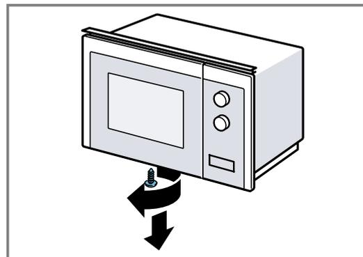
2. De afdekking aan de bodem van de magnetron verwijderen.
