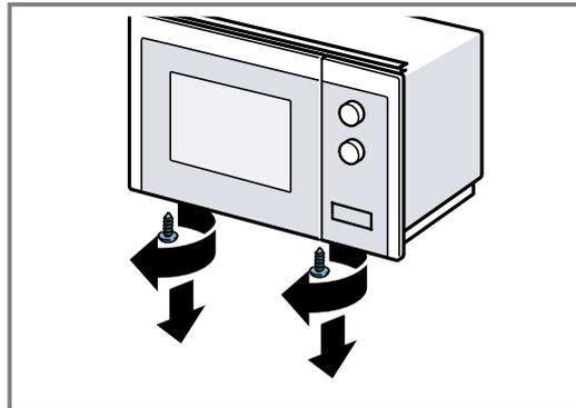
5. Fixer le cadre encastrable sur le fond du micro-ondes avec les deux vis extérieures.
