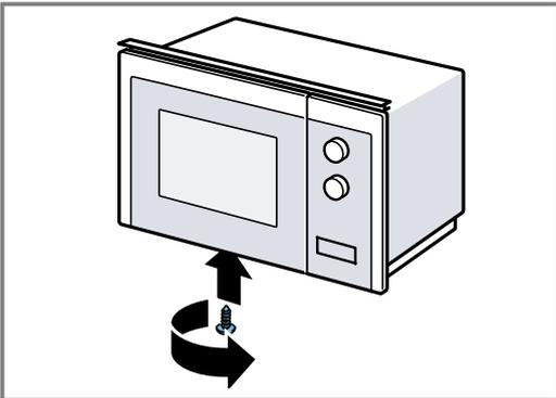
4. Die 2 äußeren Schrauben am Mikrowellenboden lösen.
