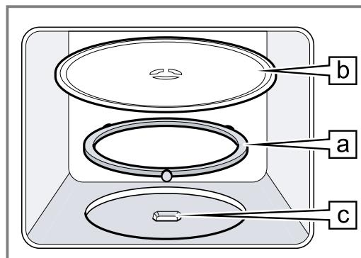
2. Den Drehteller **b** in den Antrieb **c** in der Mitte des Garraumbodens einrasten.
