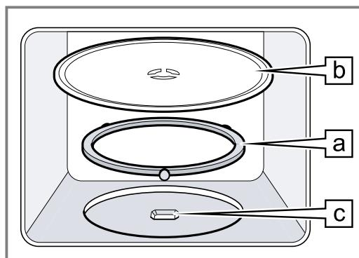
2. Encajar el plato giratorio **b** en el accionamiento **c**, en el centro de la base del compartimento de cocción.
