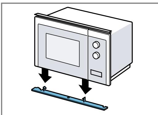
3. Die mittlere Schraube am Mikrowellenboden festschrauben.
