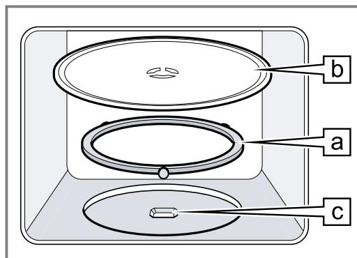
2. Encajar el plato giratorio **b** en el accionamiento **c**, en el centro de la base del compartimento de cocción.
