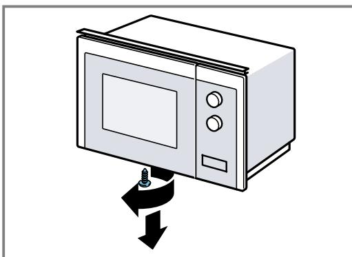
2. Die Abdeckung am Mikrowellenboden entfernen.
