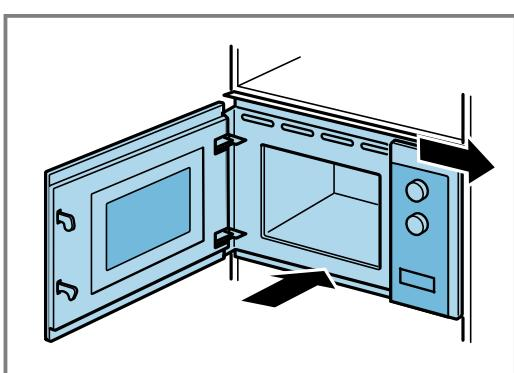
3. Das Gerät so lange festschrauben, bis das Gerät mittig ausgerichtet ist.
