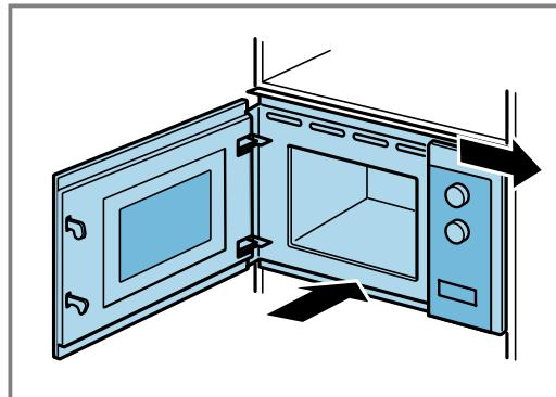
3. Skru så længe på skruerne, til apparatet er indjusteret til midten af skabet.
