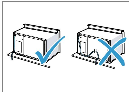
Colocar el aparato en el armario y desplazarlo hacia la derecha.
