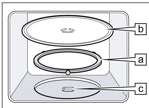
2. Snäpp fast vridtallriken **b** på drivfästet **c** mitt på ugnsbotten.
