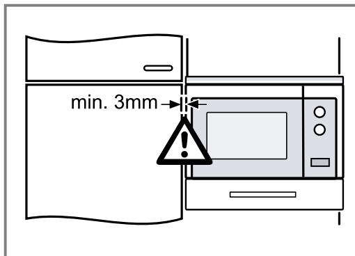
Afstanden til de tilstødende apparater skal minimum være 3 mm.
