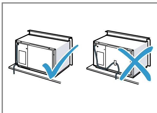
Coloque o aparelho no armário e empurre-o para a direita.
