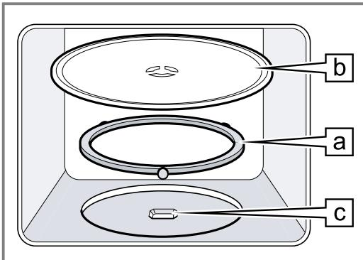
2. Encaixe o prato rotativo no acionamento , no centro do fundo do interior do aparelho.
