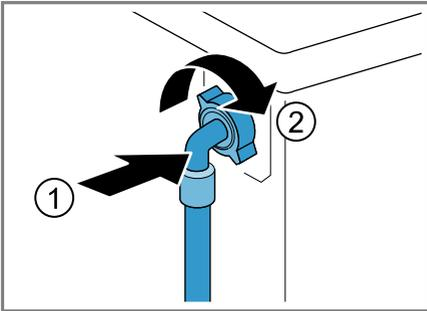
2. Den Wasserzulaufschlauch am Wasserhahn (26,4 mm = 3/4") anschließen.
