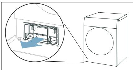
5. Filtermatte vorsichtig von der Wärmetauscher-Abdeckung ziehen.
