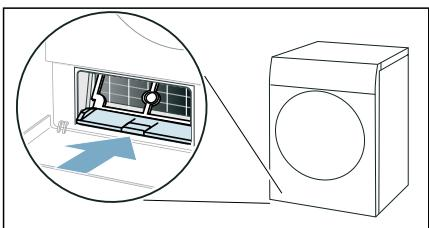
**10. Wärmetauscher-Abdeckung am Griff einschieben.**
