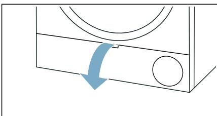
3. Hebel der Wärmetauscher-Abdeckung entriegeln.
