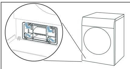
4. Wärmetauscher-Abdeckung am Griff herausziehen.
