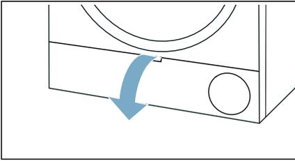
2. Hebel der Wärmetauscher-Abdeckung entriegeln.
