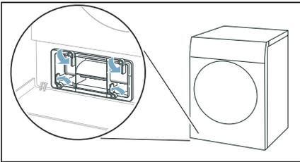
3. Wärmetauscher-Abdeckung am Griff herausziehen.
