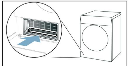
11. Wärmetauscher-Abdeckung am Griff einschieben.
