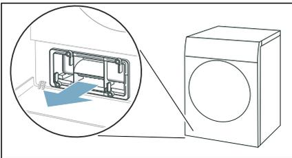
4. Alle Flusen von der Wärmetauscher-Abdeckung und dem Flusensieb entfernen.
