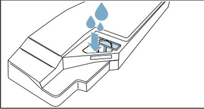
**Hinweis:** Gefüllten Kondenswasser-Behälter immer waagrecht halten, damit keine Flüssigkeit ausläuft.
