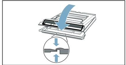
**Hinweis:** Achten Sie darauf, dass Sie das Flusendepot vollständig verschließen.
