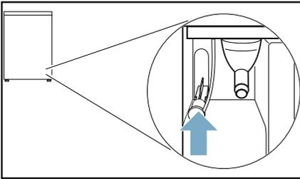
5. Ablaufschlauch bis zum Anschlag auf den freiliegenden Stutzen schieben.
