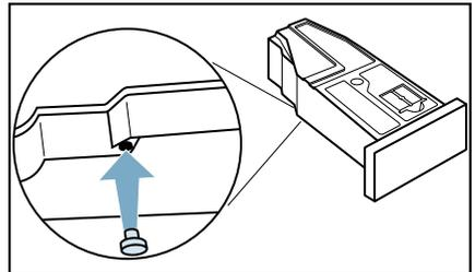
3. Sieb im Kondenswasser-Behälter reinigen. → Seite 47
