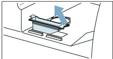
3. Das Sieb in den Wasser-Tank einsetzen.
