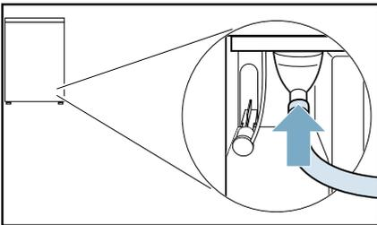
6. Die andere Seite des Ablaufschlauches, je nach Anschluss-Situation, mit dem restlichen Zubehör befestigen.
