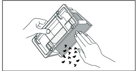
**Hinweis:** Achten Sie darauf, dass keine Verunreinigungen auf den Dichtungen der Wärmetauscher-Abdeckung verbleiben.
