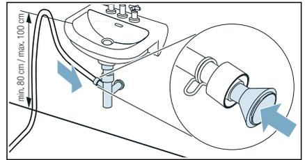
Anschluss-Stelle muss mit Schlauchschelle gesichert werden (Spannereich 12-22 mm, Fachhandel). Bei Anschluss an einen Siphon ist zu beachten, dass der Ablaufschlauch über eine Höhe von min. 80 cm, jedoch max. 100 cm geführt wird.
