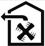
Powietrza nie wolno odprowadzać do komina, który jest używany do odprowadzania spalin z urządzeń spalających gaz lub inne paliwa (nie dotyczy urządzeń użytkowanych w trybie obiegu zamkniętego).
