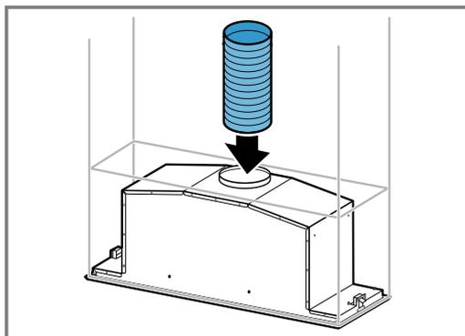
2. Wykonać połączenie z otworem powietrza wylotowego.
