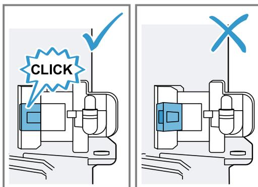
7. Insérez le filtre à graisse.
