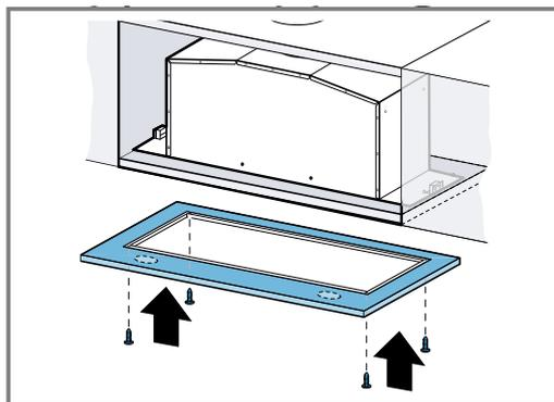
4. Ramę i urządzenie zabezpieczyć śrubami.
