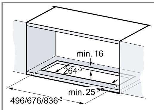
2. Wycięcie pod rurę powietrza wylotowego wykonać powyżej mebla do zabudowy lub za meblem do zabudowy.
