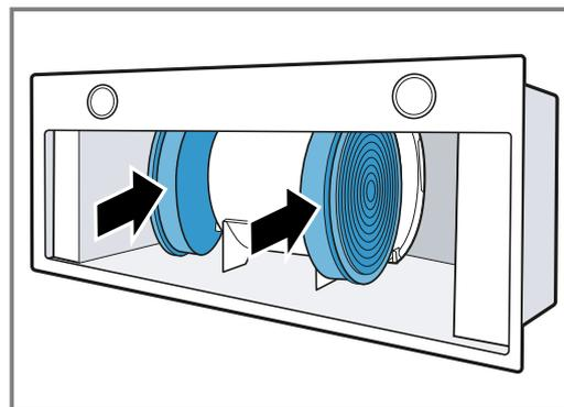
4. Zamontować filtry przeciwtłuszczowe.
