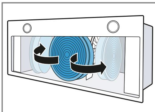
3. Pousser le filtre anti-odeurs avec précaution dans le support de fixation.
