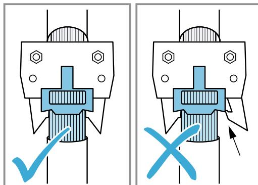
7. Insérez le filtre à graisse.
