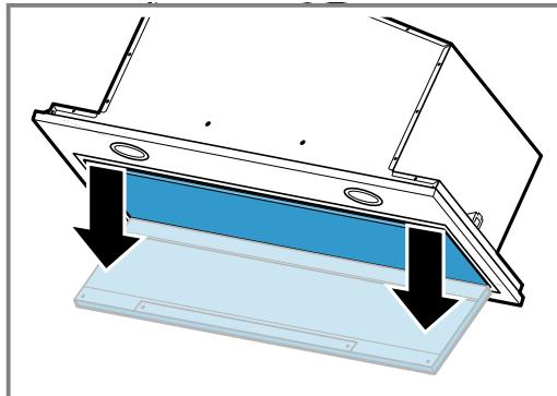
**3.** De scharnierbeveiliging losmaken en de filterafdekking verwijderen.
