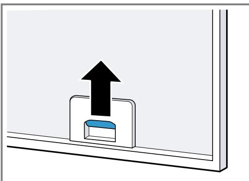
3. Retirez les filtres à graisse des fixations.
