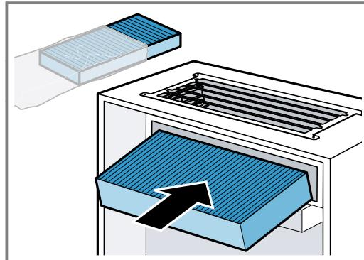
3. De afscherming zo inbrengen dat deze door de magneten wordt vastgehouden.
