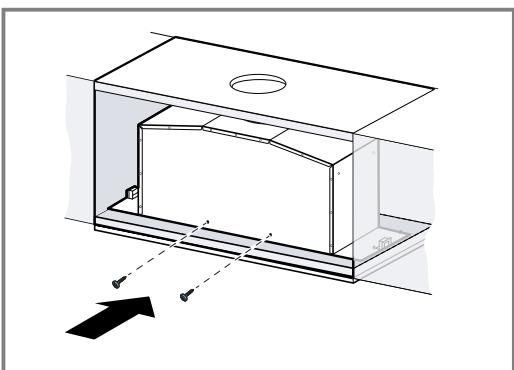
Si les vis ne sont pas accessibles de l'extérieur, elles peuvent également être montées de l'intérieur.
