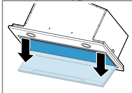
**3. Démonter le dispositif de sécurité de la charnière et retirer le capot du filtre.**
