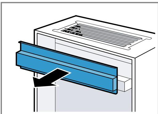
2. De geurfilter verwijderen.
