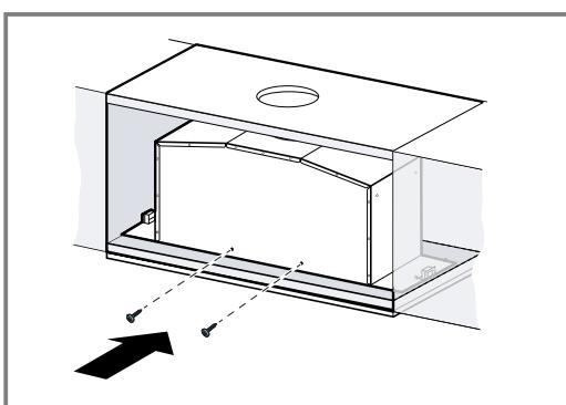
Wenn die Schrauben von außen nicht zugängig sind, können die Schrauben auch von innen montiert werden.
