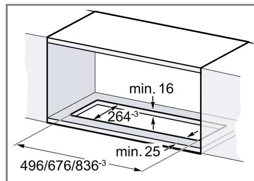
2. Den Ausschnitt für das Abluftrohr entweder oberhalb des Einbaumöbels oder hinter dem Einbaumöbel herstellen.
