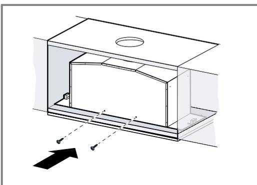
Wenn die Schrauben von außen nicht zugänglich sind, können die Schrauben auch von innen montiert werden.
