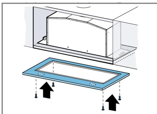
4. Fixer le cadre et l'appareil à l'aide de vis.
