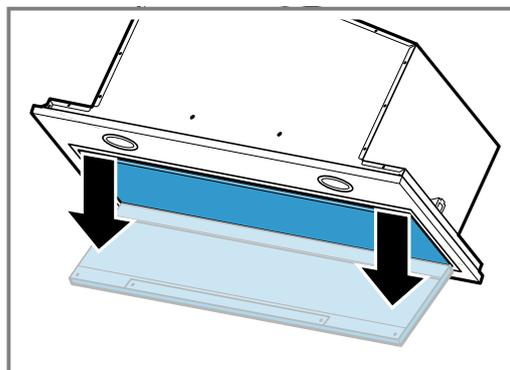
3. Démontez le dispositif de sécurité de la charnière et retirez le capot du filtre.
