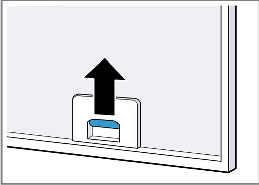
**3. Retirez les filtres à graisse des fixations.**
