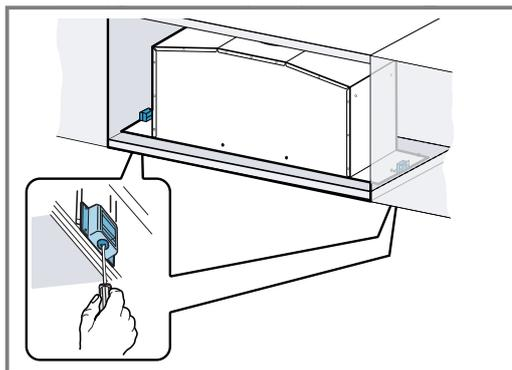
3. Mettre en place le cadre et le visser à l'appareil par le bas.
