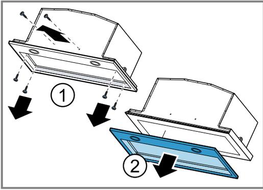
**Preparar el funcionamiento con recirculación de aire**
