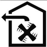
El aire no se puede desviar a una chimenea que se use para los gases residuales del aparato que quemen gas u otros combustibles (esto no se aplica a los aparatos de recirculación de aire).
