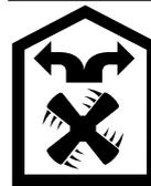
Para se poder eliminar os odores no modo de funcionamento em recirculação de ar, tem de ser montado um filtro anti-cheiros. Para poder tirar proveito das diversas possibilidades de utilização do aparelho com funcionamento por recirculação de ar, verifique o nosso folheto ou consulte o seu distribuidor. Pode adquirir os acessórios necessários junto do distribuidor, da assistência ao cliente ou na loja online.
