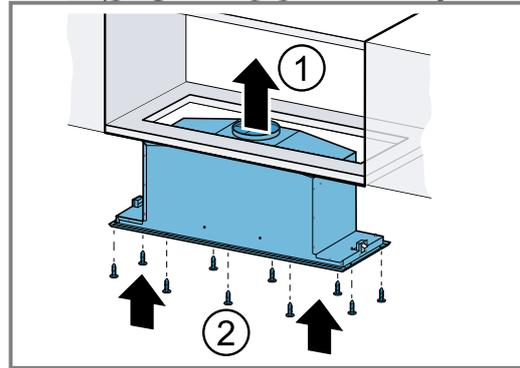
2. Aperte os parafusos de fixação.
