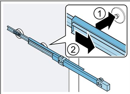
2. Insérez le rail de sortie au niveau du boulon arrière ① et faites glisser le dispositif de verrouillage vers l'arrière ②.
