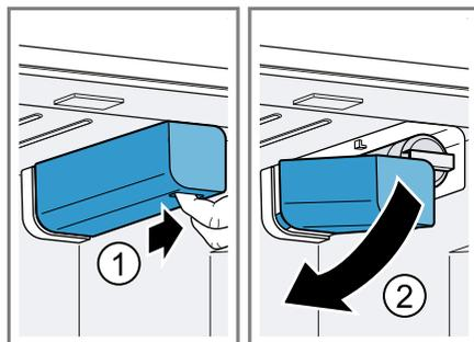
2. Tournez le filtre à eau à 90° dans le sens inverse des aiguilles d'une montre ① et retirez-le ②.
